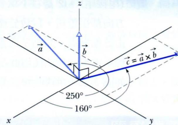
圖 3-22 向量  $\vec{c}$  (在  $xy$  平面上) 是向量  $\vec{a}$  和  $\vec{b}$  的向量(或外)積。
